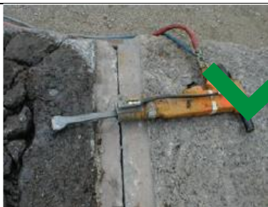
Martillo neumático equipado con sistema de suministro de agua por pulverización.
